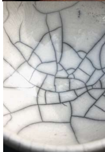
Lo smalto per raku citato sopra, applicato a vasi e su una ciotola con una mirata conduzione del raffreddamento e della successiva riduzione dopo la cottura. Essenziali lo smalto e la superficie perfettamente liscia dell'argilla! Argilla: Witgert 50/20; 1040 °C
