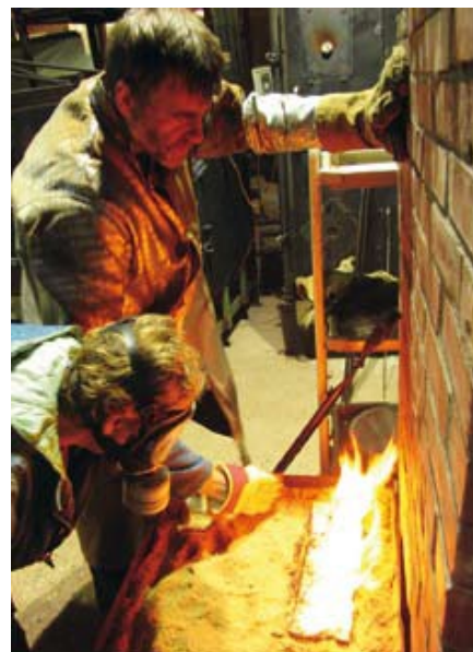
Anche la migliore ricetta per uno smalto è senza valore se la riduzione dopo la cottura non viene condotta sotto stretta e precisa osservazione.
