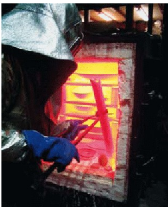
Apertura di un forno da 500 litri con rivestimento (abbigliamento) protettivo
