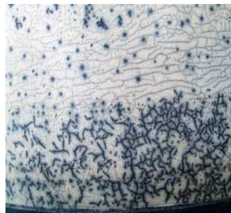
Spesso le parti solubili in acqua degli smalti a base di borace influenzano la cavillatura dello smalto in un modo molto particolare, penetrando nella superficie del corpo, formando puntini e screpolature di piccole dimensioni, dominando così la cavillatura dello smalto.
